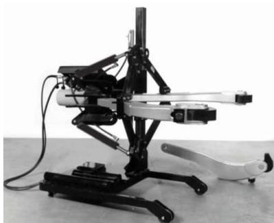
Подкатные гидравлические съемники Posi Lock обеспечивают максимальное тяговое усилие при проведении работ, связанных с демонтажем больших шестерен, дисков, колес, втулок и других деталей
