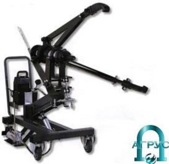
Съемники гидравлические транспортируемые – серия “AG” Удобная регулировка по высоте с помощью ножного насоса Самоцентрирующаяся конструкция Может использоваться как с 3-мя так и с 2-мя захватами Возможность изменять угол на 50 относительно центрлинии Три насадки увеличения хода штака в комплекте Безопасное и удобное использование
